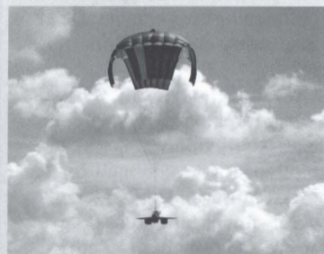
Motoren stopper, faldskærmen udløses, og airbags pustes op.
