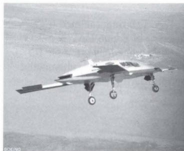
Boeings X-45A Unmanned Com- bat Air Vehicle er udviklet til U.S. Defense Advanced Research Projects Agency og flyve- våbnet. UAV'en fløj første gang den 22. maj 2003 på Dry- den Flight Research Center, som er en del af Edwards Air Force Base i Cali- fornien.
